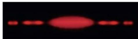
b) Figure d'interférence d'un faisceau laser par une double fente.
